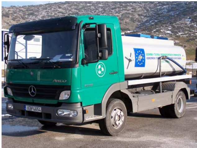
Βυτιοφόρο όχημα συλλογής, χωρητικότητας 5,5 τόνων, Σταθμός Μεταφοράς Πάτρας
